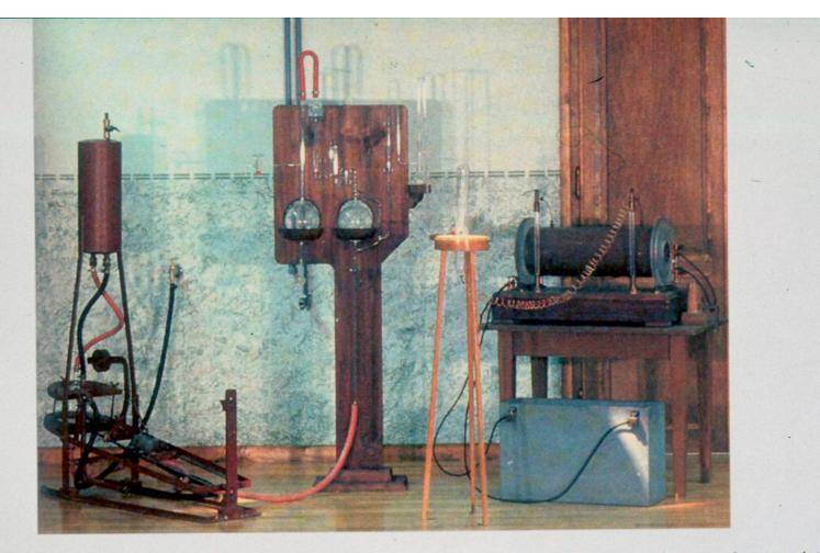
Die von Röntgen bei seinen Experimenten benutzte Versuchsanordnung ist rechts im Bild rekonstruiert worden. Auf dem Tisch erkennt man den Rühmkorffschen Funkeninduktor.
