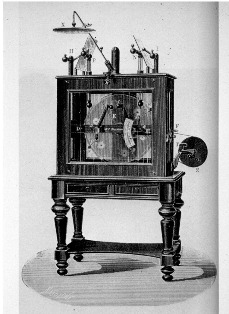
Influenz-Elektroverschine vom Typ Eulenburg-Hirschmann, beliebte Stromquelle für die Elektrodiagnostik und -therapie gegen Ende des 19. Jahrhunderts.
